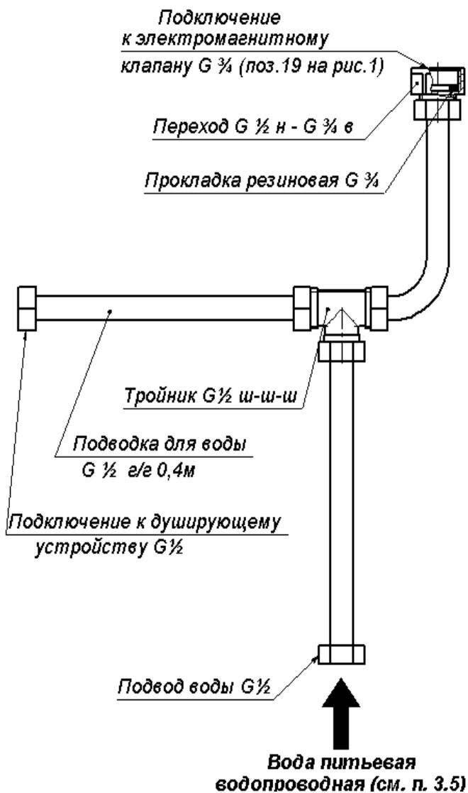
Рис.4. Подключение к водопроводной сети.
