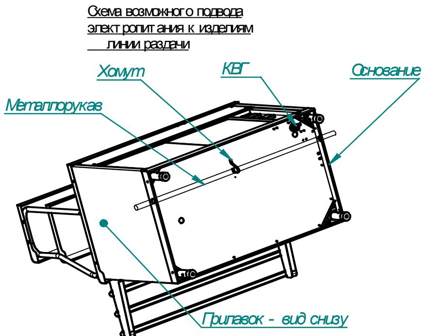
В основаниях изделий линии раздачи введено сквозное отверстие диаметром 29,5 мм и поддерживающие хомуты для возможности и проведения металлического гибкого рукава с питательными кабелями сквозь все изделия линии раздачи.
