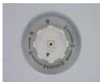
Для минибара со сплошной дверцей, внутренняя температура колеблется от 0°C до 10°C. Вы можете повернуть ручку терmostата для выбора нужной температуры. Поверните ручку, вращая по часовой стрелке в диапазоне шкалы от 1 до 6. Параметр шкалы «1» является максимальной температурой, а установка параметра «6» - минимальной температурой. Минибар будет выключен при установке термостата на значение «0».
