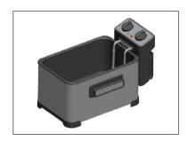
Вдвиньте панель управления с нагревательным элементом на боковую часть внешнего металлического корпуса и вдавите их вниз, пока они не встанут в свое усадочное место. **ВАЖНО!** На панели управления фритюрницы находится аварийный микровыключатель. Убедитесь, что этот микровыключатель нажимает защелка на внешнем металлическом корпусе. Фритюрница не будет работать, пока панель управления не будет правильно установлена на внешнем корпусе.
