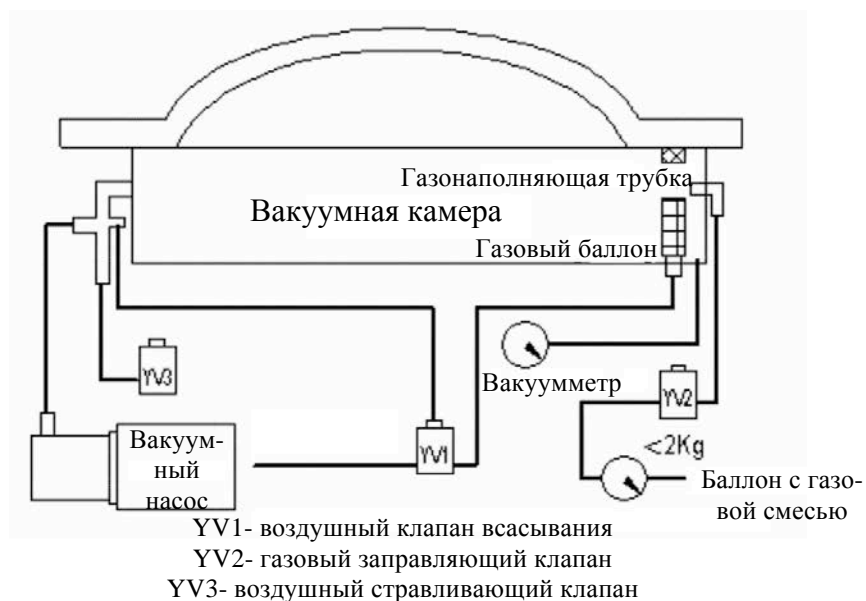
Схема вакуумного упаковщика с системой газации
