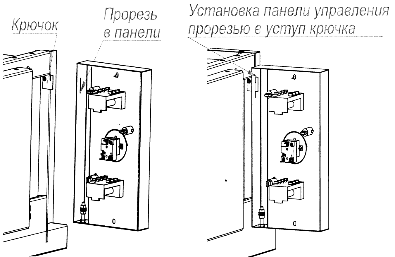
Рис. 5. Технологическое окно для замены контрпетли.
