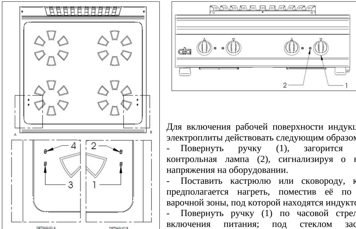
Для включения рабочей поверхности индукционной электроплиты действовать следующим образом:
