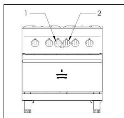
контрольная лампа горит постоянно, указывая на наличие напряжения, а оранжевая гаснет, как только духовка выйдет на установленную температуру;
