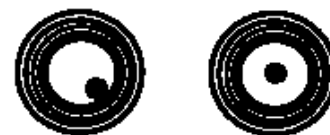
НЕПРАВИЛЬНО ПРАВИЛЬНО Рисунок 5.1 – Установка уровня
