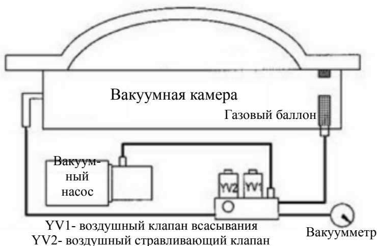
Схема вакуумного упаковщика с производительностью вакуумного насоса 10 м 3
