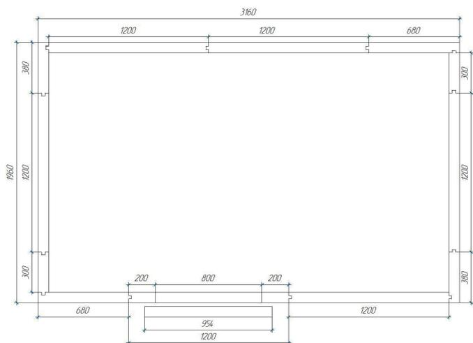
Схема построения стен (вид сверху)
