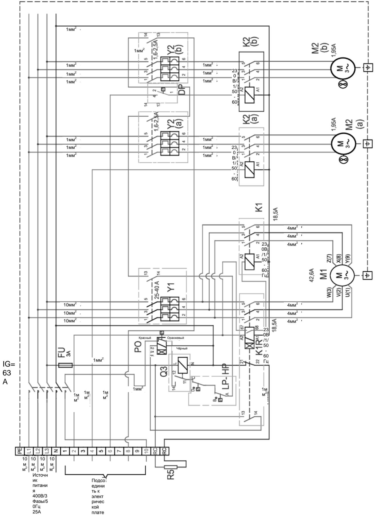
SCHEMA ELETTRICO CELLA – СХЕМА ПОДКЛЮЧЕНИЯ КАМЕРЫ - ELEKTROSCHALTPLAN CELL
