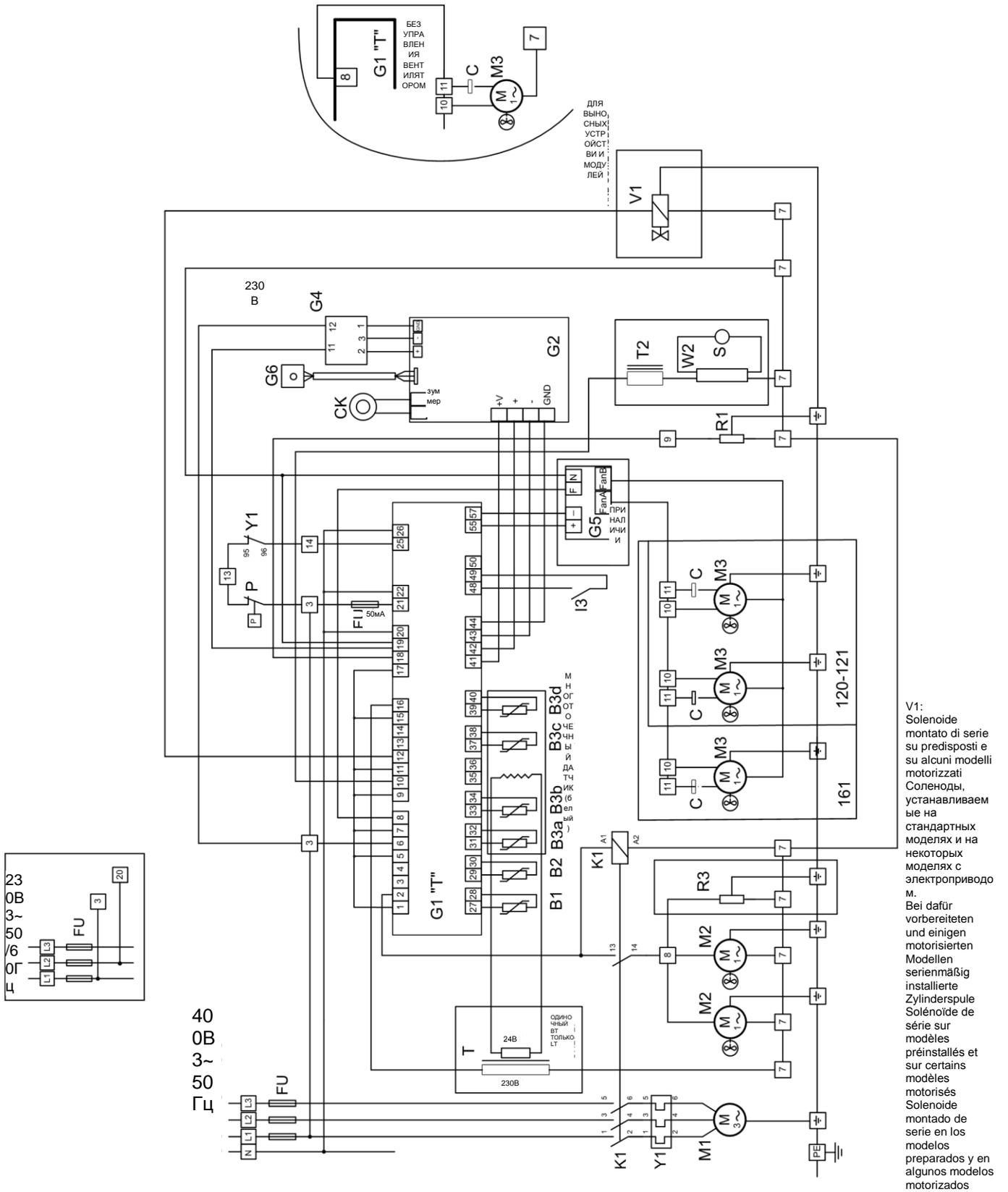
V1: Solenoide montato di serie su predisposti e su alcuni modelli motorizzati Solenoide, installiamo su standardi modelli e su alcuni modelli con elettroprivato M. Bei dafür vorbereiteten und einigen motorisierten Modellen serienmäßig installierte Zylinderspule Solenoide de série sur modèles préinstallés et sur certains modèles motorisés Solenoide montado de serie en los modelos preparados y en algunos modelos motorizados
