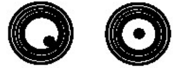
НЕПРАВИЛЬНО ПРАВИЛЬНО Рисунок 5.1 – Установка уровня
